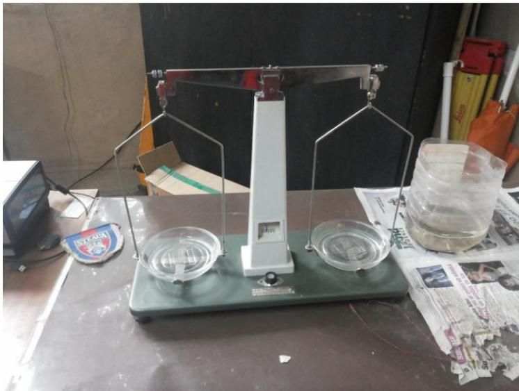
**Fig. 42 - ANALYTICAL BALLANCE FOR SPECIFIC WIGHT DETERMINATIONS**
